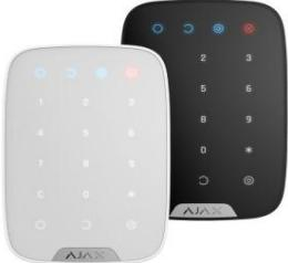
Bežična unutrašnja tastatura osetljiva na dodir za upravljanje Ajax bezbednosnim sistemom. Dizajniran za unutrašnju upotrebu.KeyPad je zaštićen od pokušaja pogađanja lozinke i može pokrenuti tih alarm kada se lozinka unese pod prililom.Podržava lozinke od 4-6 cifara. Sistem se može aktivirati bez lozinke.Baterija obezbeđuje do 2 godine autonomnog rada.Dimenzije 150 × 103 × 14 mm
