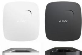
Bežični detektor požara sa senzorima temperature i ugljen-monoksida koji nadgleda sigurnost u sobi dvadeset četiri sata dnevno i odmah obaveštava o opasnom nivou CO, dimu i naglim skokovima temperature.Osetljivi element: Fotoelektrični, CO i temperaturni senzori. Prag aktiviranja + 59 ° C ± 2 ° C.Anti-sabotaža: Zaštita od prevara, Otkrivanje ometanja, Otporan na zloupotrebu.Dimenzije 132 × 132 × 31 mm.
