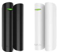
Bežični detektor otvaranja obaveštava o prvim znacima upada u sobu kroz vrata ili prozor. Instalira se čak i na krovne prozore koji mogu da ostanu otvoreni pri izlasku iz kuće. Spoljni kontakt je dostupan za povezivanje nezavisnih detektora. Uređaj otkriva otvaranje vrata ili prozora pomoću britanskih hi-end prekidača na koje deluje magnetno polje. Komplet uključuje dva magneta: veliki magnet instaliran je na rastojanju do 2 cm, a mali do 1 cm. Dimenzije 90 x 20 mm.
