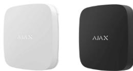
Bežični detektor poplave otkriva prve znakove curenja u roku od milisekundi. Instalira se bez upotrebe alata. Uredaj otkriva prve znakove poplave čim voda dospe na jedan od četiri para kontakata na dnu detektora. Ima zaštitu IP65 kućišta, što znači da je u potpunosti zaštićen od prašine i vlage. Anti-sabotaža: Zaštita od prevara, Otkrivanje ometanja. Dimenzije  $56 \times 56 \times 14\text{ mm}$ .
