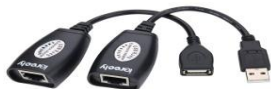
USB EKSTENDER USB eksternder služi za prenos signala preko USB porta od najviše 30 metara pomoću jednog UTP kabla kategorije 5e ili boljeg
